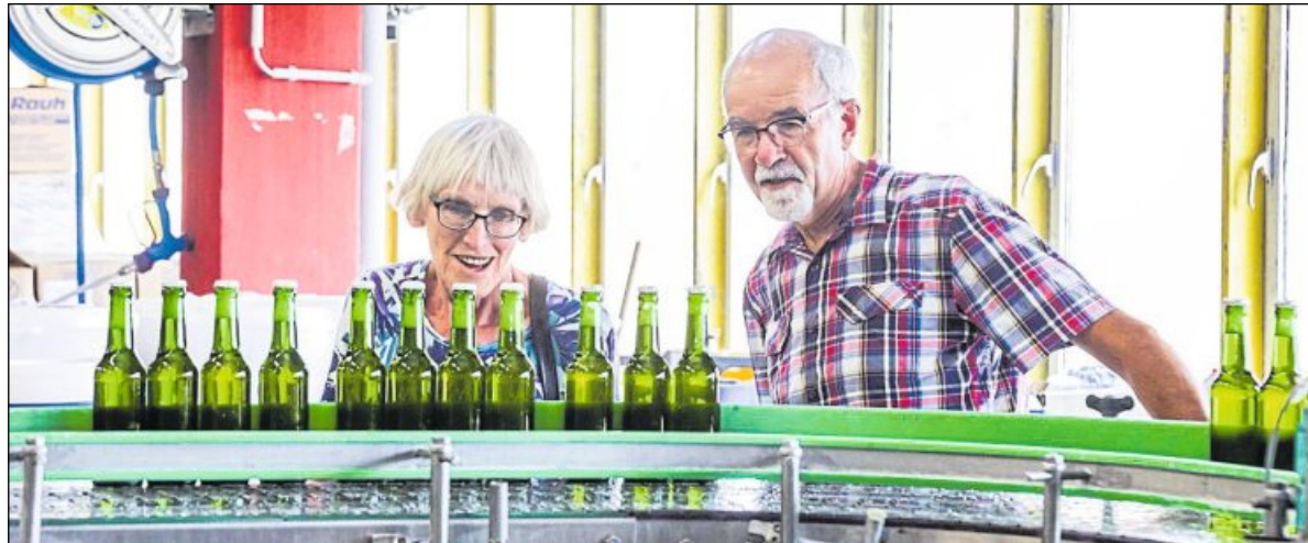
IN DER FLASCHENABFÜLLEREI läuft vieles vollautomatisch. Bis zu 11 500 Flaschen können pro Stunde mit dem edlen Gerstensaft befüllt werden, nachdem sie in der Flaschenwaschmaschine aufwendig gereinigt wurden.
